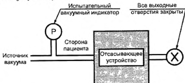
Рисунок А.5 — Схема измерения максимального допускаемого вакуума
