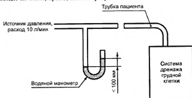
Рисунок А.6 — Испытание устройства для дренажа грудной клетки положительным давлением
