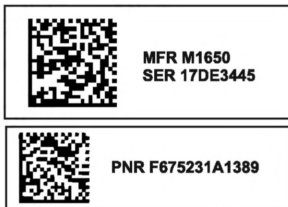
Рисунок 5 — Вариант маркировки компонента с минимальным составом данных и представлением MFR, SER, PNR в символах ШК и в алфавитно-цифровой форме для визуального чтения
