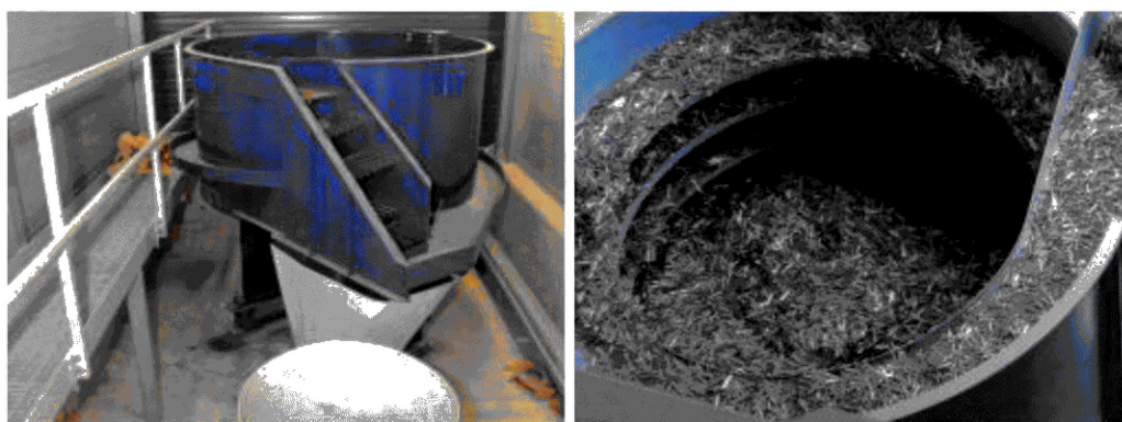
Рисунок В.2 — Дозатор для подачи фибры в бетономеситель
