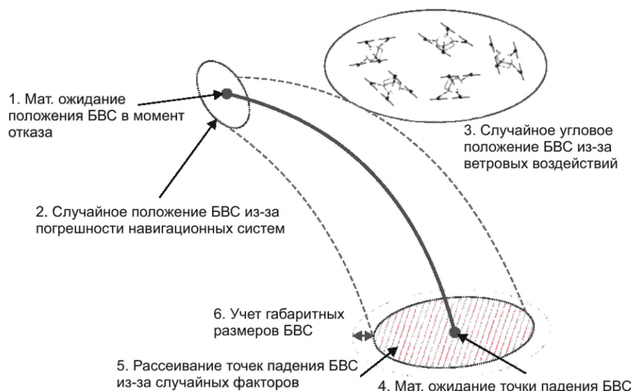
Рисунок Б.3 — Пример схемы моделирования последствий отказного состояния БВС
