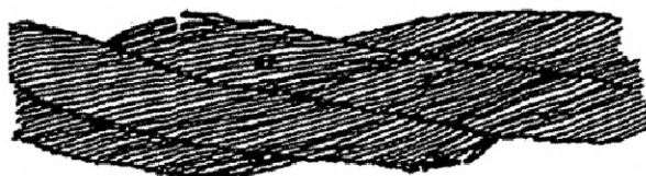
Рисунок Н.1 — Обрывы и смещения проволок каната крестовой свивки
