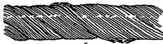
б) в канате односторонней свивки
