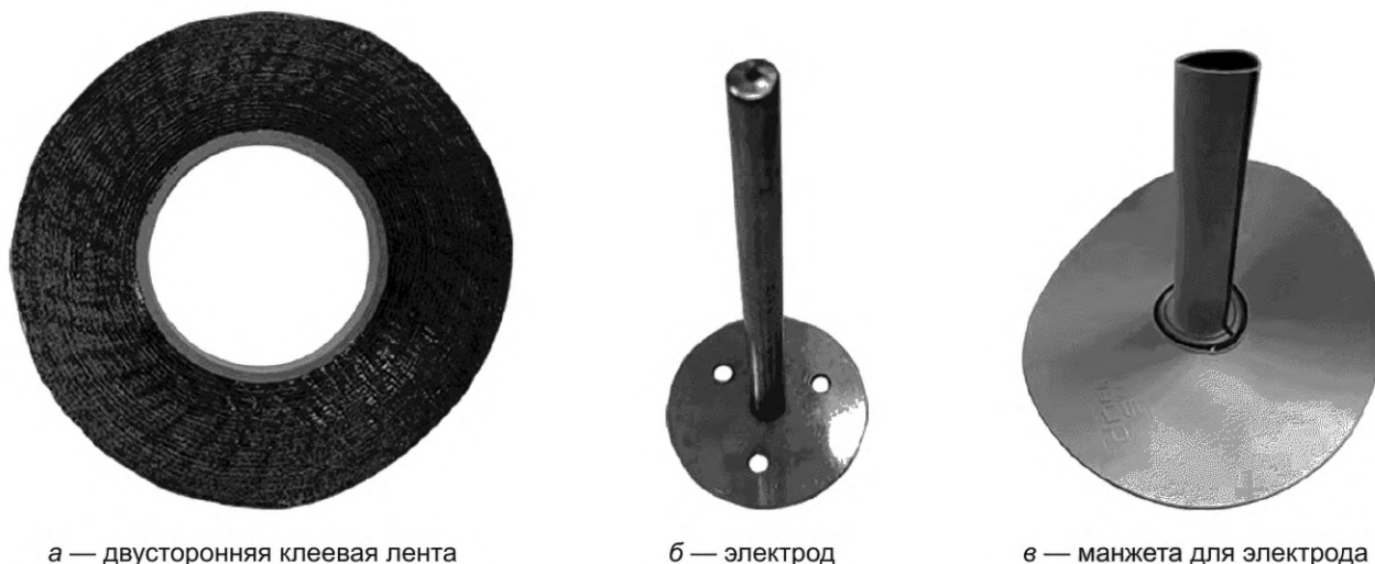
Рисунок 3 — Вспомогательные материалы для монтажа слоя
