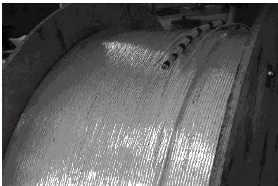
Рисунок 18 — Схема укладки кабелей на барабане
