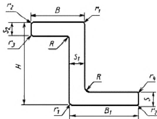
$B, B_1$  — длина;  $H$  — высота;  $S, S_1, S_2$  — толщина;  $r, r_1, r_2, r_3, r_4$  — радиусы притупления;  $R$  — радиус скругления
