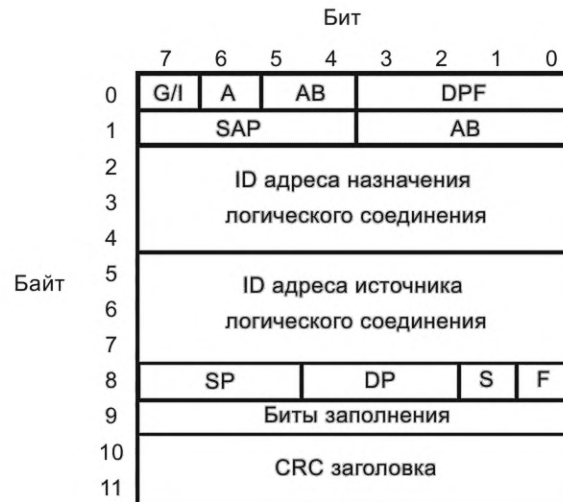
Рисунок 115 — Специальный первый блок заголовка для пакета коротких неопределенных данных
