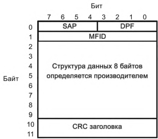
Рисунок 113 — Второй блок заголовка пакета частных данных
