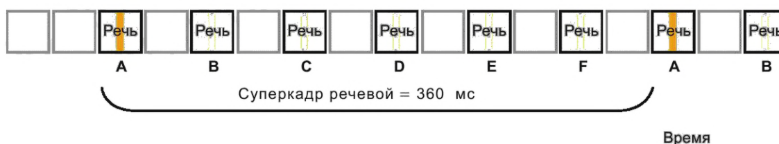
Рисунок 26 — Продолжение передачи речевого суперкадра
