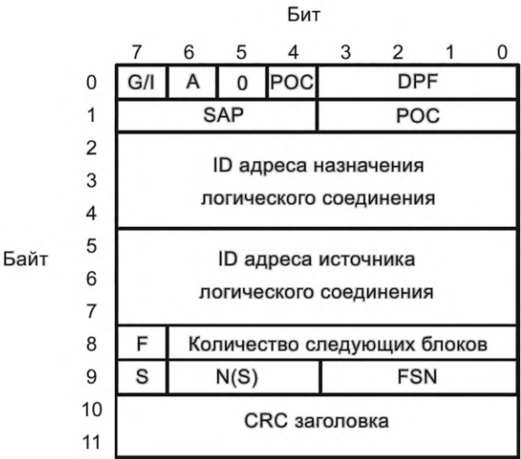
Рисунок 111 — Специальный первый блок заголовка для подтверждаемого пакета
