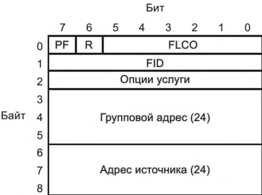
Рисунок 59 — Структура заголовка Full LC для группового вызова
