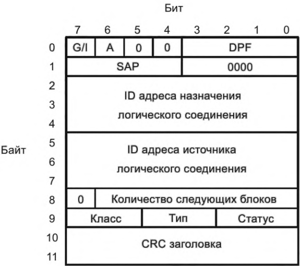
Рисунок 112 — Специальный первый блок заголовка для ответного пакета
