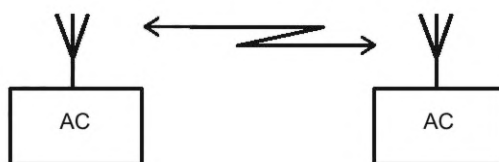
Рисунок 1 — Структурная схема организации подвижной радиосвязи в прямом конвенциональном режиме
