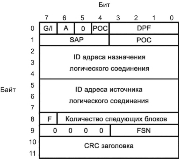
Рисунок 110 — Специальный первый блок заголовка для неподтверждаемого пакета
