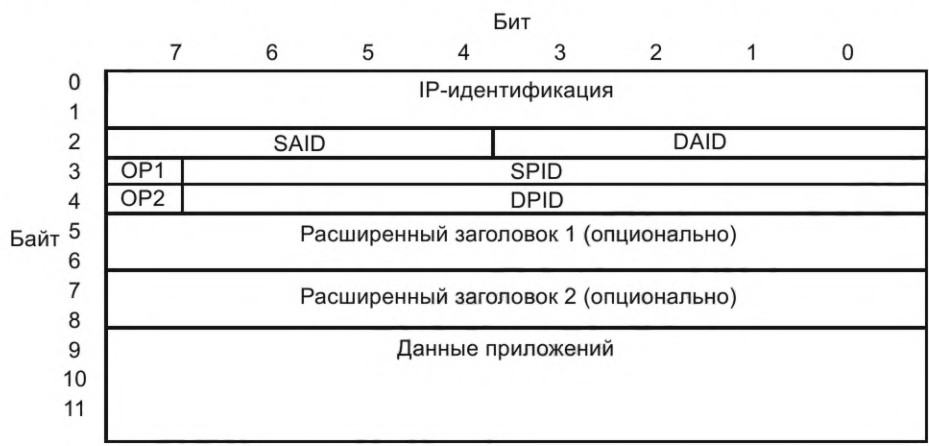
Рисунок 52 — Структура первого блока неподтверждаемых данных с FEC, со скоростью кодирования 1/2 и со сжатием заголовка UDP/IPv4
