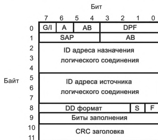
Рисунок 116 — Специальный первый блок заголовка пакета определенных коротких данных
