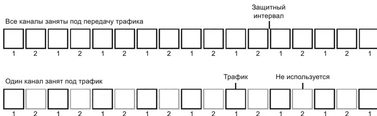
Рисунок 22 — Варианты передачи информации с помощью каналов с защитным временным интервалом
