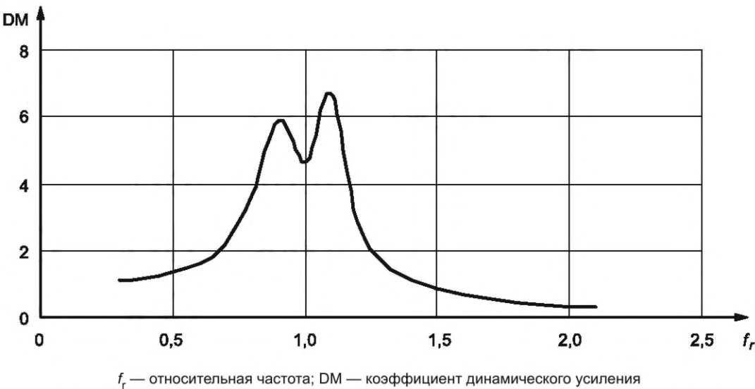
Рисунок 16 — Отклик по перемещению для системы с двумя степенями свободы при увеличенном вспомогательном демпфировании [см. рисунок 13 б)]
