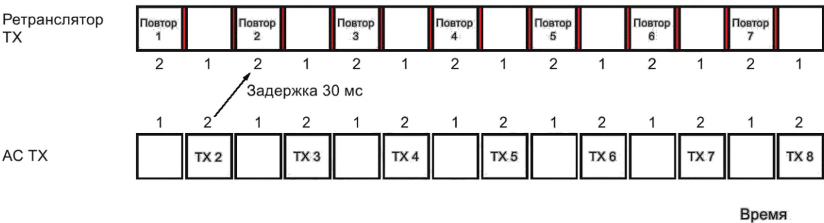
Рисунок 22 — Временные параметры речевых ретранслированных смещенных каналов с задержкой 30 мс
