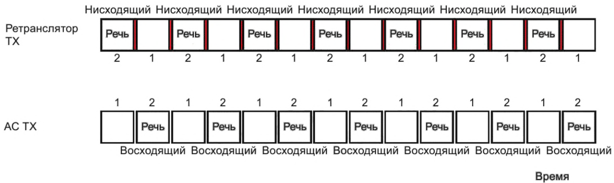
Рисунок 25 — Временные параметры речи TDD
