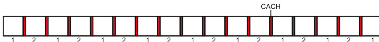
Рисунок 13 — Нисходящий канал с CACH (ретранслятор TX) при двухчастотной ретрансляции
