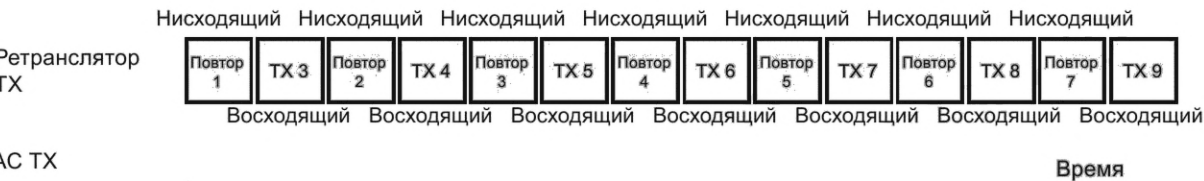
Рисунок 24 — Временные параметры одночастотного ретранслятора
