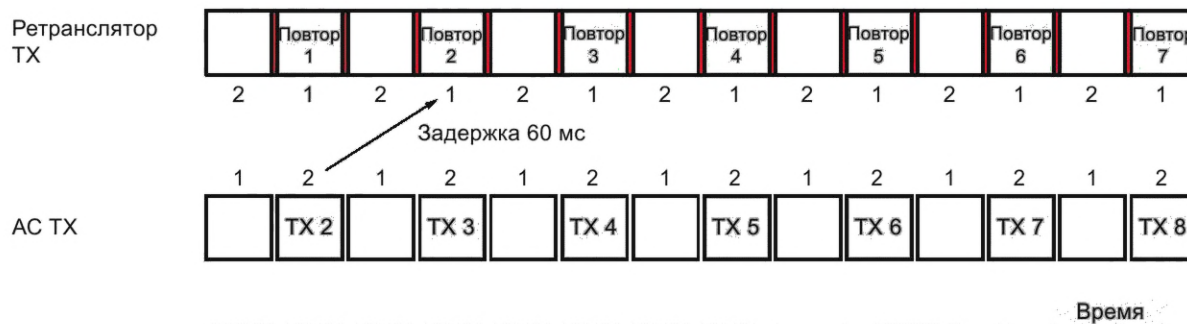
Рисунок 21 — Временные параметры выровненных каналов ретранслятора
