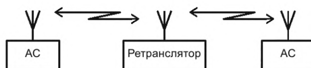
Рисунок 1 — Структурная схема организации подвижной радиосвязи с использованием ретрансляторов сигналов
