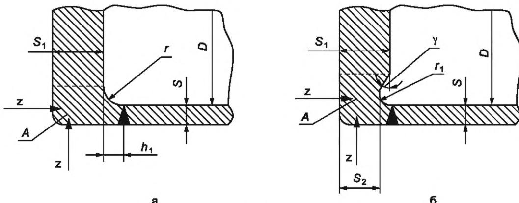
$D$  — внутренний диаметр обечайки;  $S$  — толщина обечайки;  $S_1$  — толщина фланца;  $S_2$  — наименьшая толщина фланца в месте кольцевой выточки;  $h_1$  — длина отбортовки фланца;  $z$  — радиус закругления фланца;  $r_1$  — радиус кольцевой выточки;  $\gamma$  — угол проточки фланца
