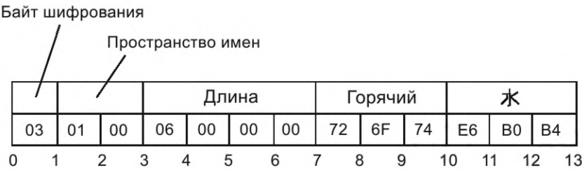
Рисунок 7 — Строковый NodeId, определяемый шифрованием и идентификатором
