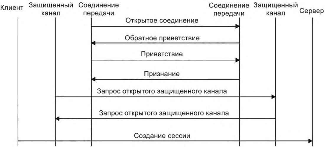
Рисунок 14 — Инициированное сервером соединение по протоколу соединения OPC UA
