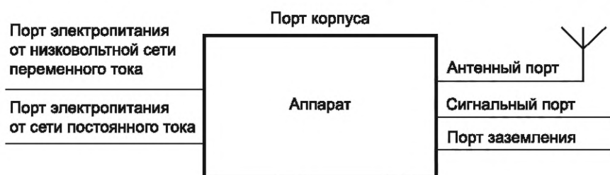
Рисунок 1 — Порты входа электромагнитных помех в устройство
