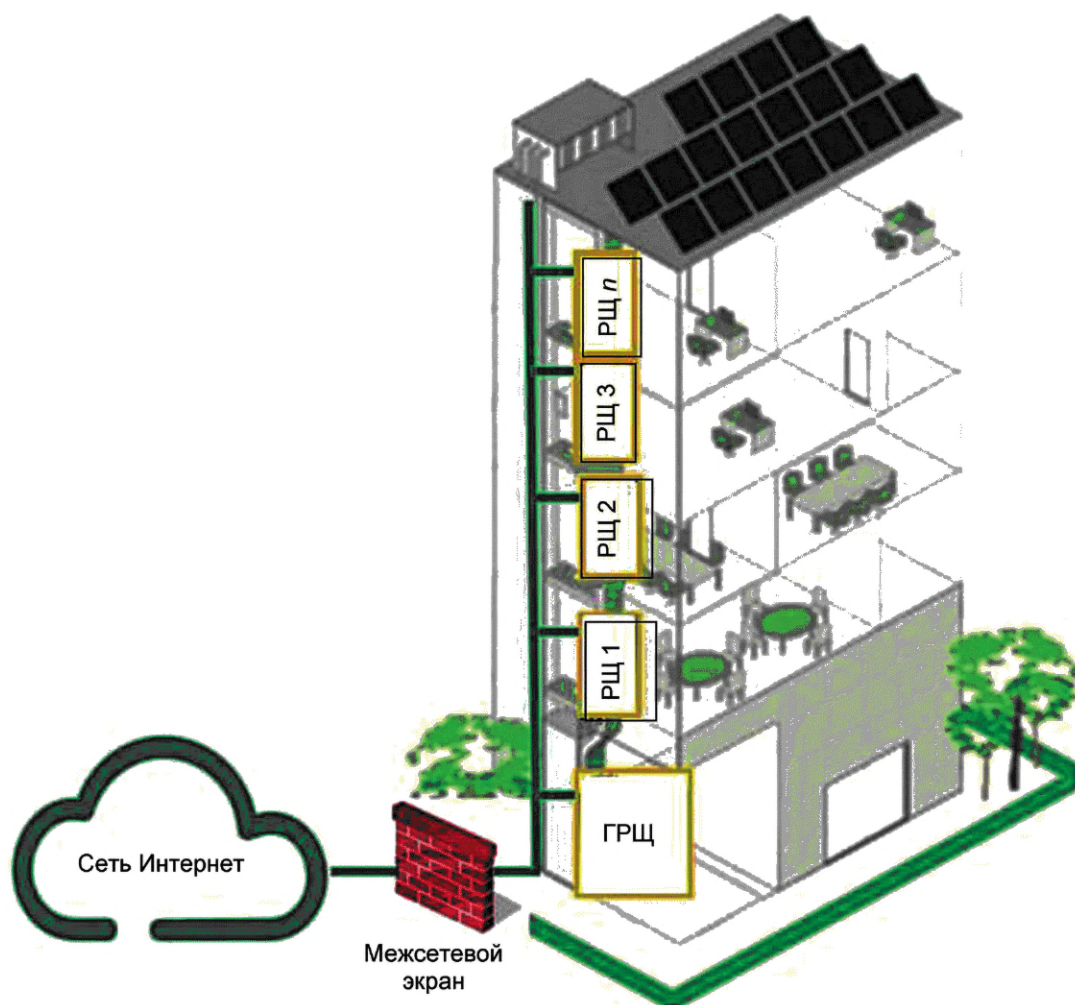
Рисунок Б.1 — Электрическая архитектура здания
