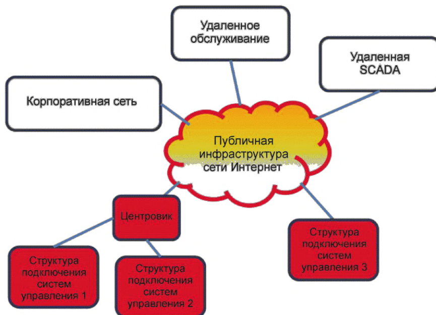
Рисунок 5 — Структура подключения систем управления C5
