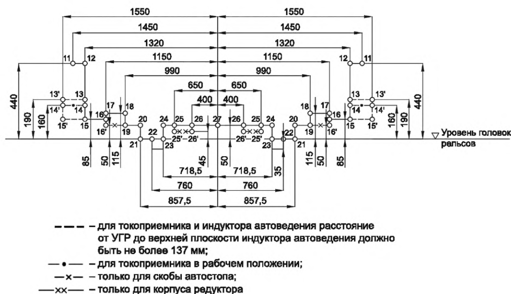
Рисунок 11 — Габарит М. Нижнее очертание габарита М
