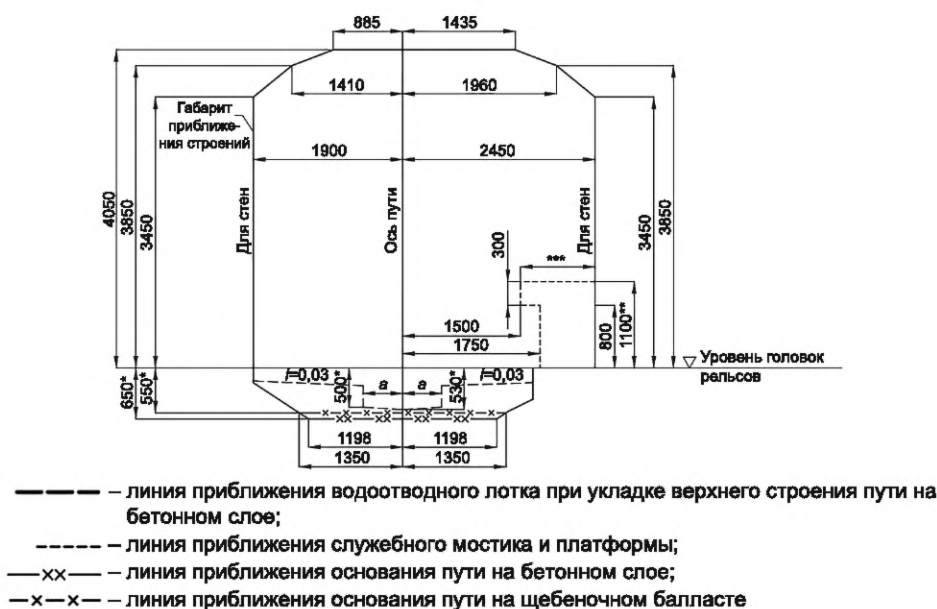
Рисунок 2 — Габарит C_{мп} для тоннелей прямоугольного очертания, сооружений устройств наземных и надземных участков на перегонах
