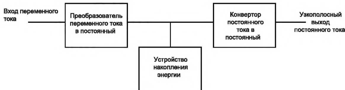
Рисунок В.2 — Топология двойного преобразования
