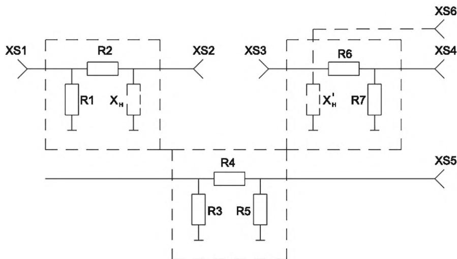
XS1 — гнездо для подключения генератора; XS2, XS3 — гнезда для подключения фильтра; XS4, XS5 — гнезда для подключения аппаратуры для измерения ослабленных уровней напряжений на выходе фильтра и на выходе согласующего устройства; R1—R7 — сопротивления;  $X_h$ ,  $X'_h$  — реактивные составляющие входного и выходного нагрузочных полных сопротивлений  $Z_{вх}$ ,  $Z_{вых}$
