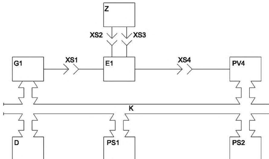
G1 — генератор синусоидальных сигналов программируемый; D — процессор; Z — измеряемый фильтр; E1 — согласующее
