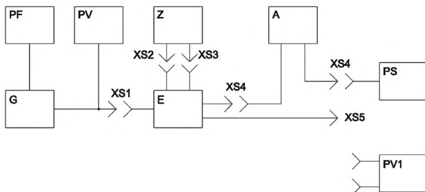
PF — частотомер электронно-счетный (при необходимости); G — генератор синусоидальных сигналов; PV — вольтметр; Z — измеряемый фильтр; E — согласующее устройство; A — усилитель (при необходимости); PS — измеритель затуханий; PV1 — вольтметр или измеритель отношений уровней; XS1 — гнездо для подключения генератора; XS2, XS3 — гнезда для подключения фильтра; XS4, XS5 — гнезда для подключения вольтметра или измерителей к выходу и входу фильтра (выходы измерительного и опорного каналов)
