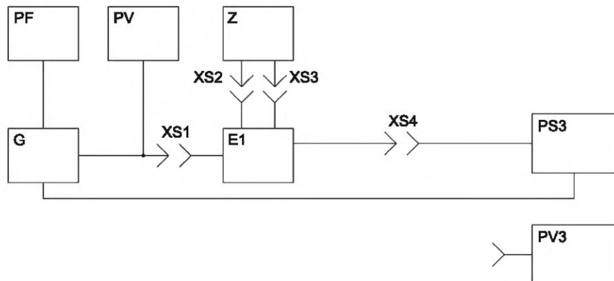
PF — частотомер электронно-счетный (при необходимости); G — генератор синусоидальных сигналов; PV — вольтметр;
