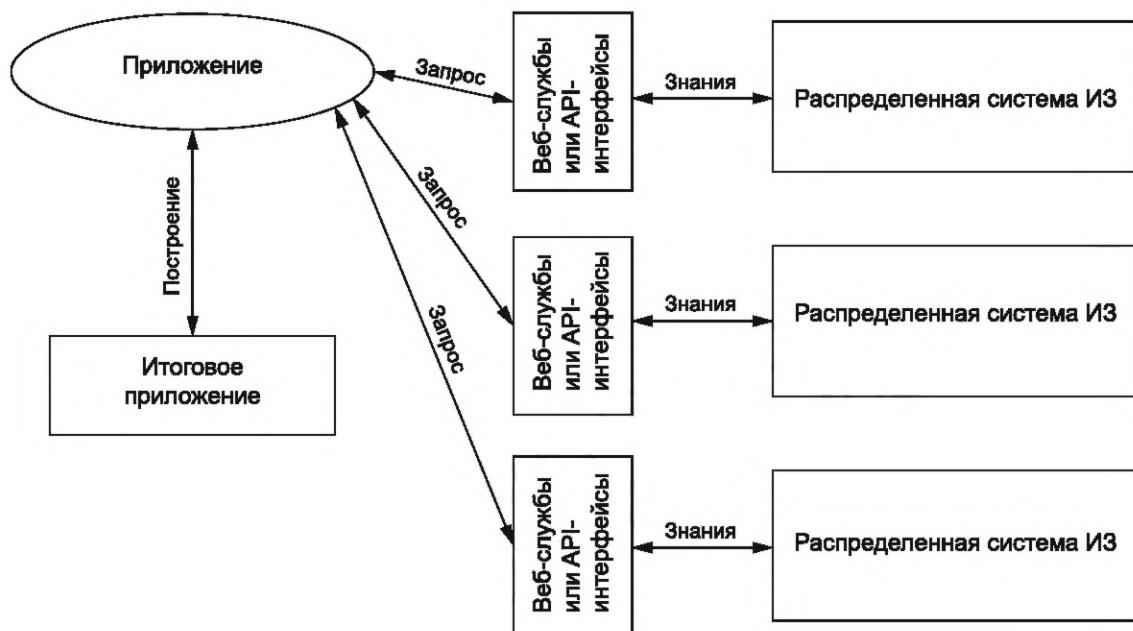
Рисунок 5 — Архитектура распространения инженерии знаний
