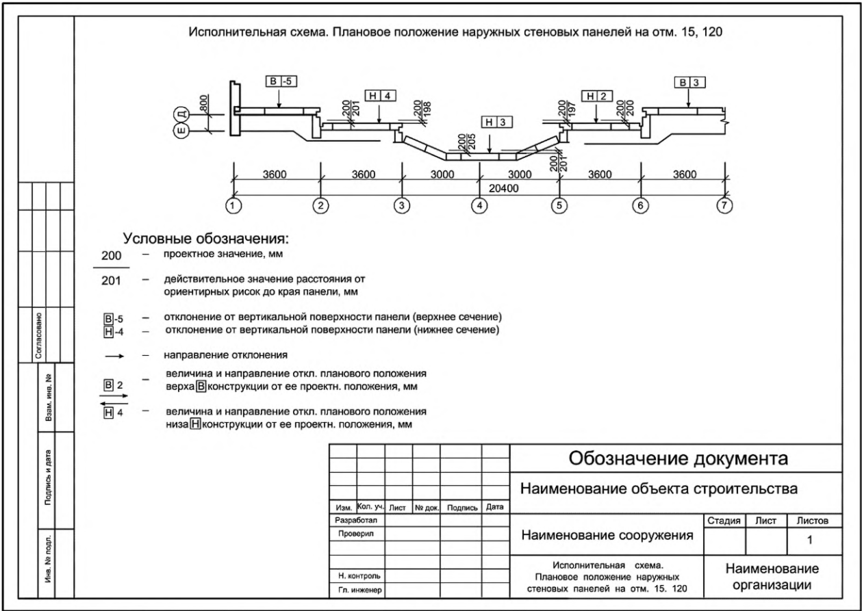
Рисунок Б.14 — Исполнительная схема. Наружные стеновые панели этажа жилого дома (плановое положение)
