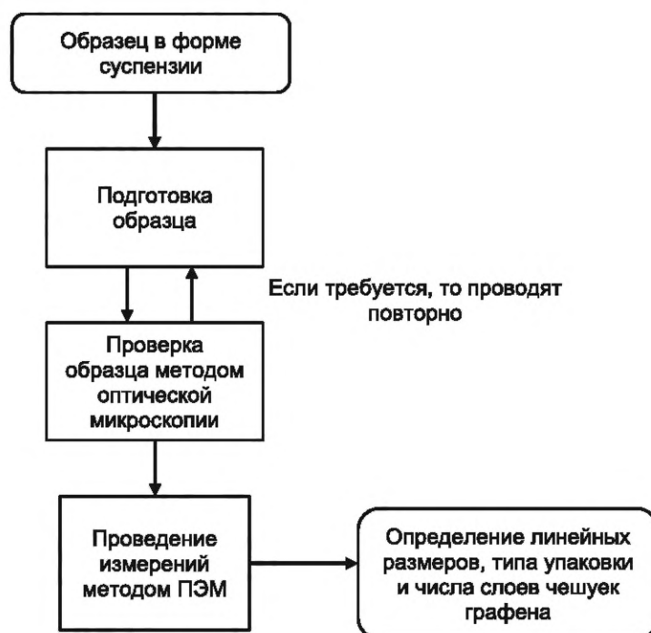
Рисунок 5 — Блок-схема (алгоритм) проведения измерений методом ПЭМ для определения линейных размеров, типов упаковки и числа слоев чешуек графена
