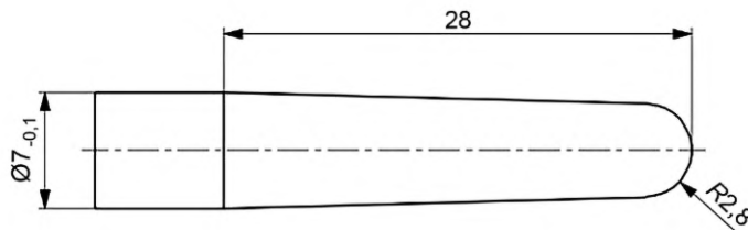
Рисунок 2 — Шаблон пальца для плетеной сетки
