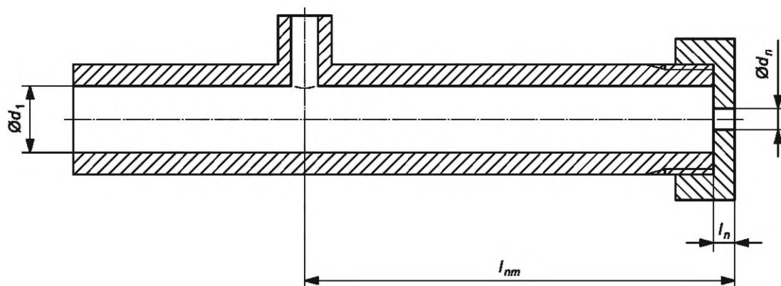
$d_n$  — диаметр отверстия сопла, равный  $(4,0 \pm 0,1)$  мм;  $l_n$  — длина отверстия сопла, равная  $(4,0 \pm 0,1)$  мм;  $d_1$  — внутренний диаметр трубы, равный  $(12,5 \pm 1,0)$  мм;  $l_{nm}$  — расстояние между отверстием сопла и манометром, равное  $(80 \pm 1)$  мм
