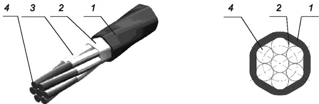
1 — индивидуальная оболочка; 2 — защитная смазка или парафин; 3 — защитное покрытие проволок цинком или цинковым сплавом Zn95Al5; 4 — стальной канат типа K7
