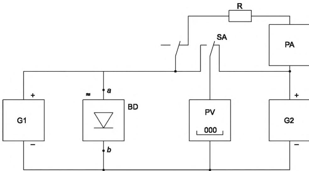
G1 — источник тока считывания; BD — детектор; SA — переключатель; PV — вольтметр;
