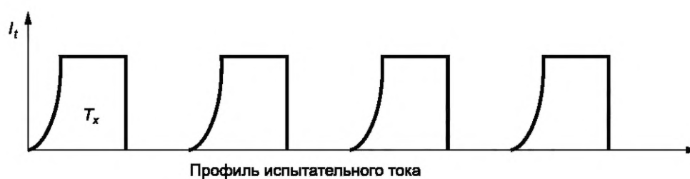
Рисунок F.1 — Профиль испытания на тепловую стабильность
