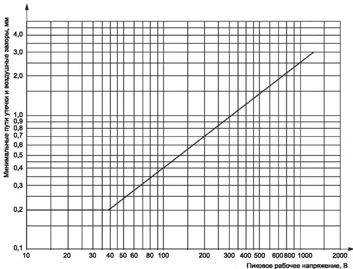
Кривая определяется по формуле:  $\log d = 0,78 \log (U/300)$  с минимальным отклонением 0,2 мм, где  $d$  — расстояние;  $U$  — пиковое напряжение (В).
