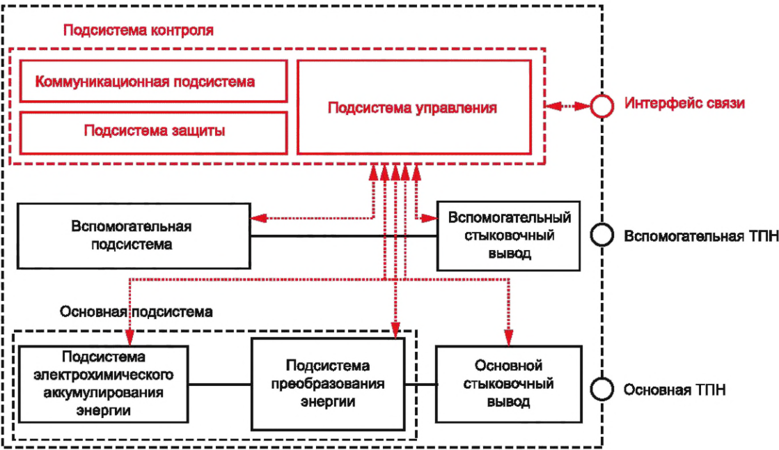
Рисунок 2 — Пример архитектуры СНЭЭБ
