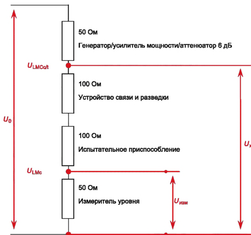
Рисунок G.5 — Схема расположения оборудования для установки уровня
