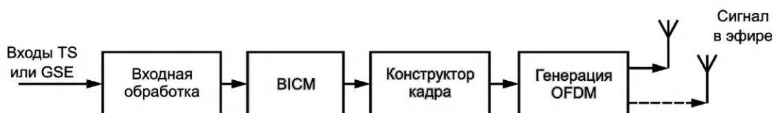
Рисунок 1 — Высокоуровневая структурная схема физического уровня NGH для профиля MIMO
