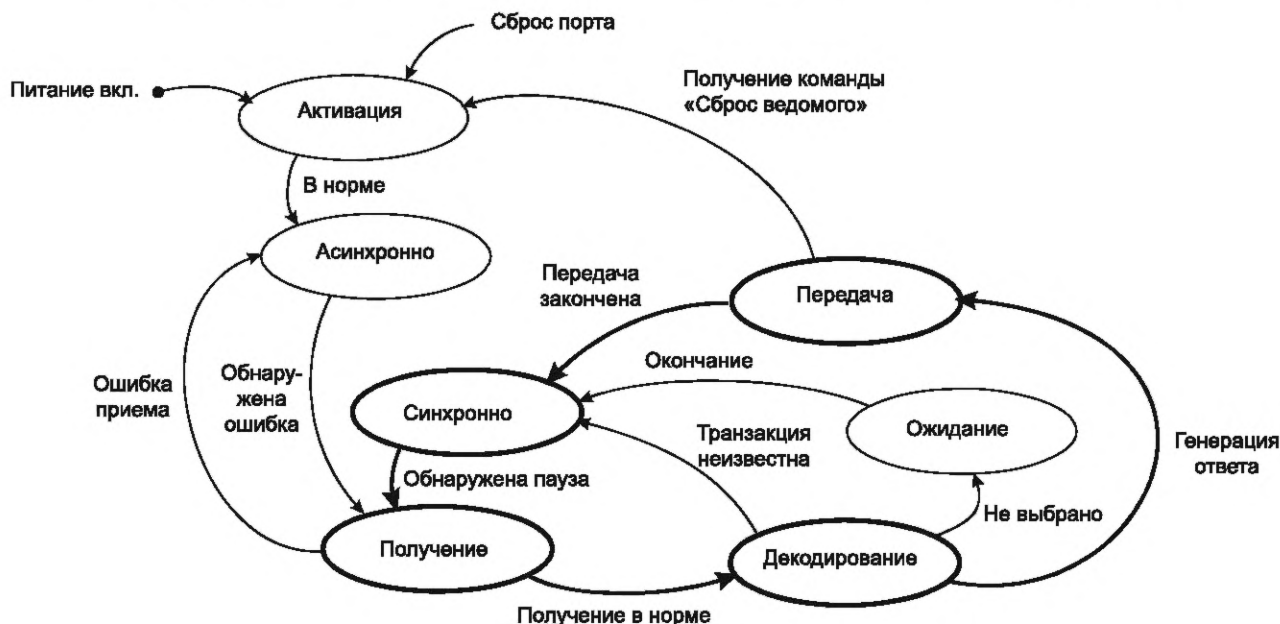
Рисунок 51 — Диаграмма основных состояний ведомого устройства AS-i
