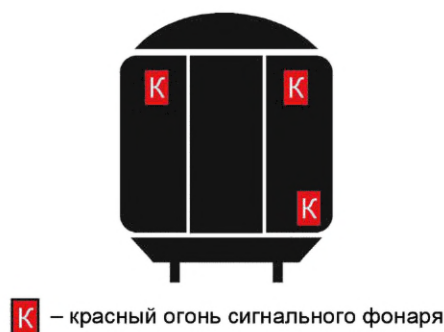
Рисунок 1 — Размещение сигнальных фонарей на торцевых стенах вагона
