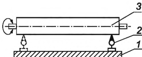
1 — опорная балка; 2 — средство измерений; 3 — подающий валец
