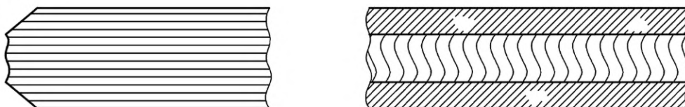
Рисунок 15 — Притупленная кромка (есть необработанные участки)
