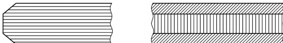
Рисунок 17 — Гладко шлифованная кромка (нет необработанных участков)
