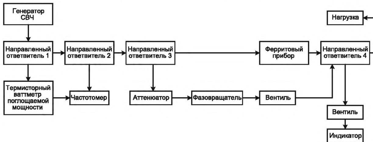
Рисунок 2 — Структурная схема установки для измерения фазового сдвига на высоком уровне мощности методом II
