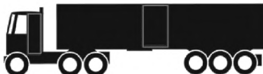
Рисунок Б.1 — Схема шестиосного седельного автопоезда (трехосный седельный тягач с полуприцепом)
