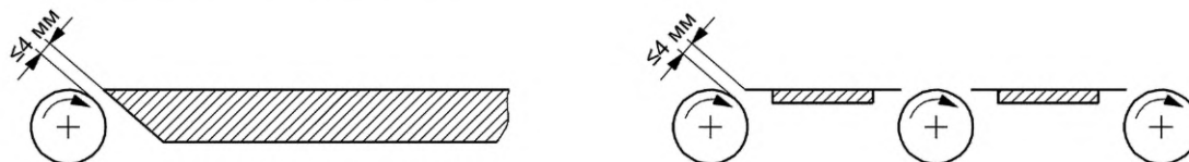
Рисунок 4 — Пример защиты роликового конвейера
