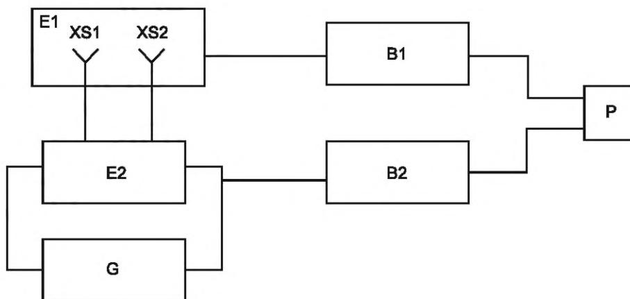
E1 — термостатирующая камера; G — генератор с измерительным четырехполюсником в цепи положительной обратной связи (E2); B1 — преобразователь температуры в напряжение; B2 — преобразователь динамического сопротивления в напряжение; P — графопостроитель
