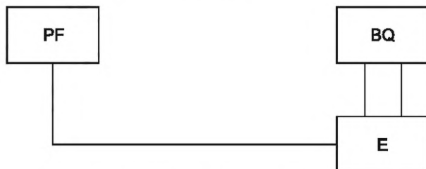
Рисунок 1 — Структурная схема измерения ослабления нежелательных резонансов для затуханий свыше 20 дБ
