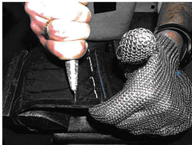
Рисунок В.3 — Шаг 1. Вырезание части протектора покрышки с использованием ножа и перчаток, защищающих от порезов
