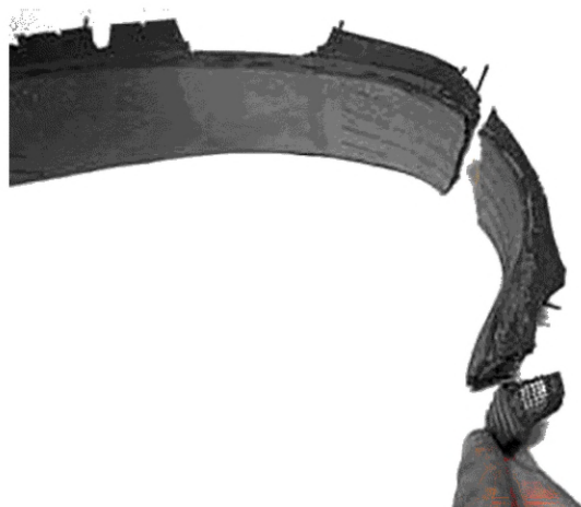
Рисунок В.9 — Шаг 2. Отрезание боковой части покрышки от протектора и бортового кольца
