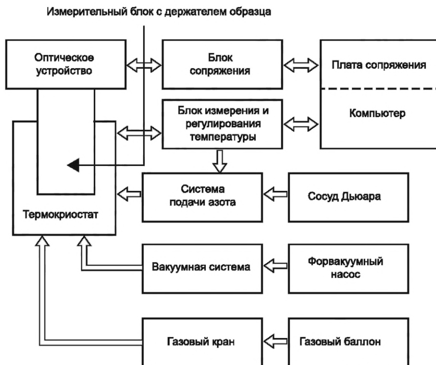
Рисунок Б.3 — Функциональная блок-схема ГПД
