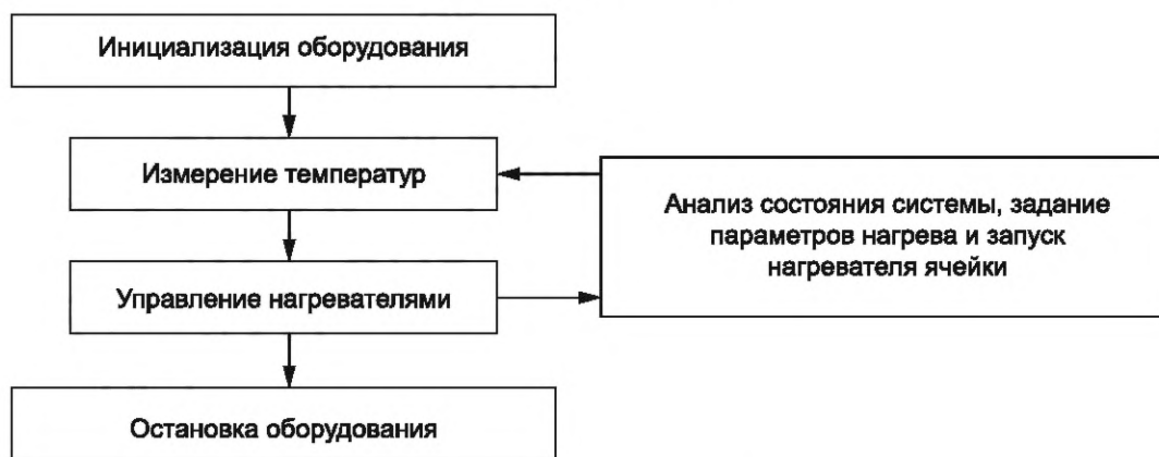
Рисунок Б.6 — Алгоритм управления оборудованием
