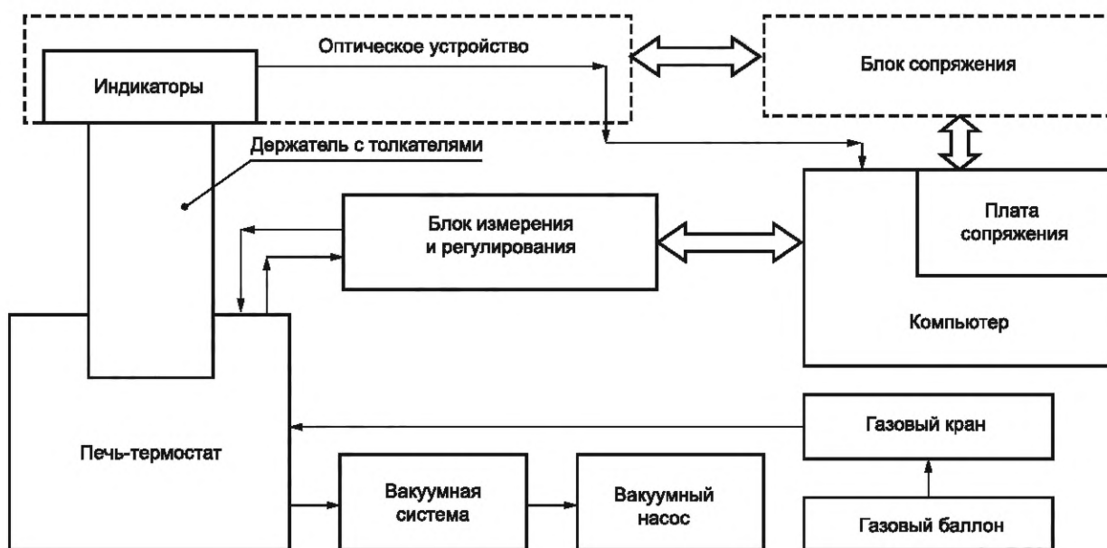
Рисунок Б.1 — Функциональная блок-схема ВДТ
