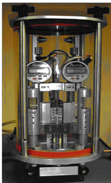
Рисунок Б.2 — Конструкция блока индикаторов
