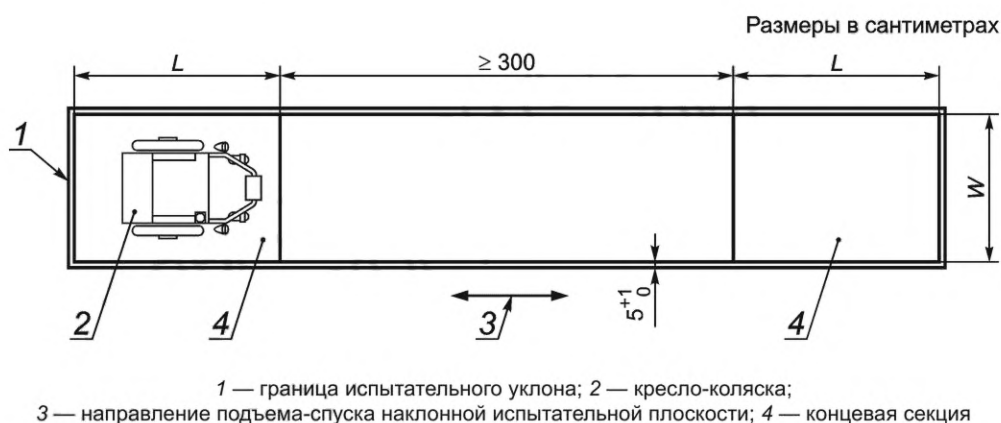
Рисунок 6 — Схема испытательного уклона
