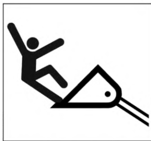
Рисунок А.8 — Падение с поднятого ковша погрузчика
