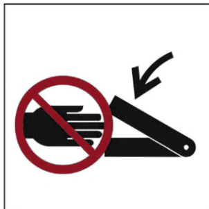
Рисунок В.16 — Не прикасайся к частям машины в зоне раздавливания
