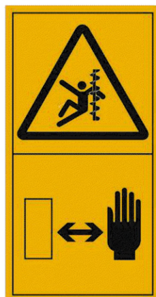
Рисунок С.25 — Затягивание руки или кисти в шнек. Соблюдай безопасное расстояние от источника опасности
