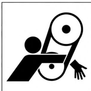
Рисунок А.30 — Затягивание кисти и руки. Ременная передача
