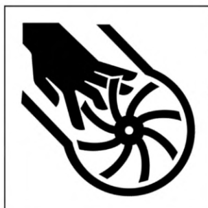
Рисунок A.23 — Отрезание пальцев или кистей рук. Лопасть рабочего колеса
