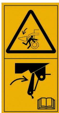
Рисунок С.10 — Раздавливание всего тела. Перед входом в опасную зону установи блокированное устройство. Читай руководство по эксплуатации
