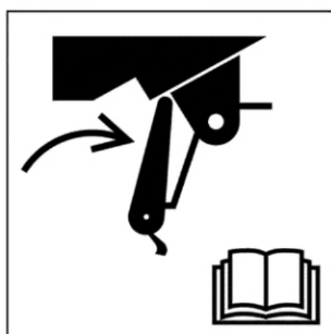
Рисунок В.10 — Перед входом в опасную зону установи блокировочное устройство. Читай руководство по эксплуатации
