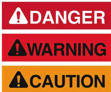
Рисунок 4 — Содержание панелей с указанием тяжести опасности
