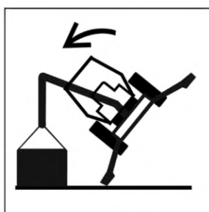
Рисунок A.41 — Опрокидывание машины. Перегруз. Экскаватор-погрузчик
