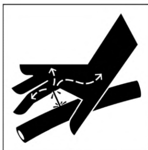
Рисунок А.9 — Жидкость под высоким давлением. Опасность проникновения в ткани
