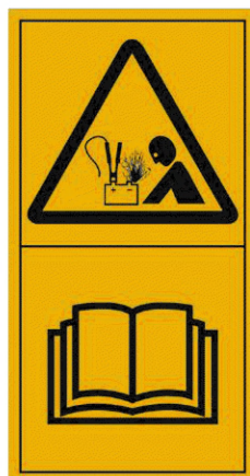
Рисунок С.19 — Взрыв аккумуляторной батареи. Запуск. Читай руководство по эксплуатации
