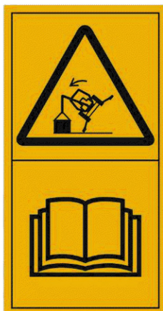
Рисунок С.32 — Опрокидывание машины или перегруз. Читай руководство по эксплуатации
