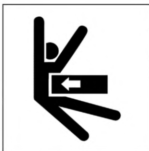
Рисунок А.15 — Раздавливание всего тела. Силовое воздействие сбоку
