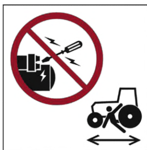
Рисунок D.26 — Пример символического изображения с общим запрещающим знаком для обозначения запрещенного действия
