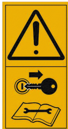
Рисунок С.12 — Общее предупреждение об опасности. Заглуши двигатель и достань ключ зажигания перед проведением работ по техническому обслуживанию или ремонту
