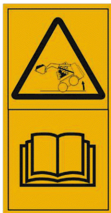
Рисунок С.33 — Опрокидывание машины или перегруз минипогрузчика. Читай руководство по эксплуатации
