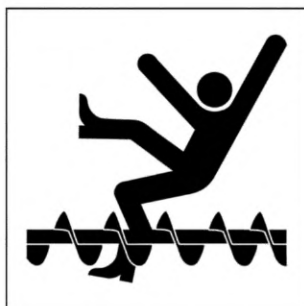
Рисунок А.34 — Затягивание ноги или ступни. Шнек
