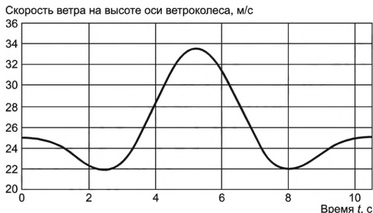
Рисунок 2 — Пример экстремального рабочего порыва
