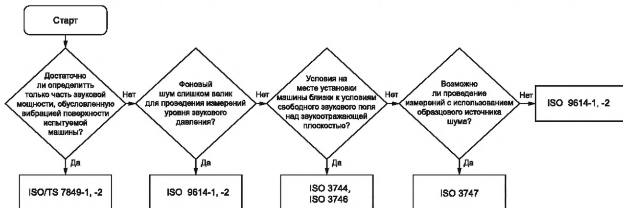
Рисунок 2 — Блок-схема процедуры выбора базового стандарта для измерений уровня звуковой мощности на месте установки машины
