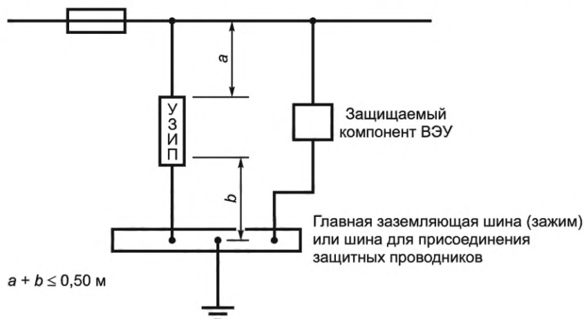
a — схема монтажа УЗИП, когда полная длина соединительных проводников не превышает 0,5 м (по ГОСТ Р 50571.5.53—2013 , рисунок 53D)
