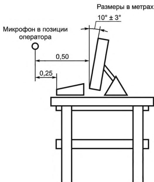
Рисунок ДА.4d — Установка оборудования типа моноблок
