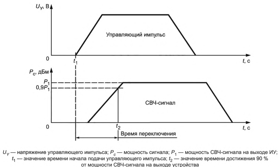
Рисунок 10 — Определение времени переключения по осциллограмме
