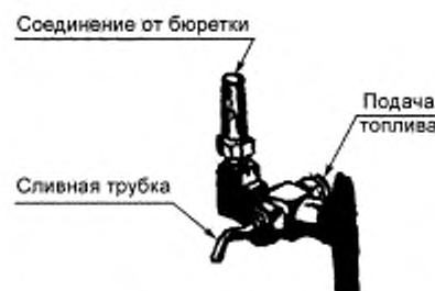
Рис. Б.2 — Типовой трехходовой кран для приготовления эталонных топлив
