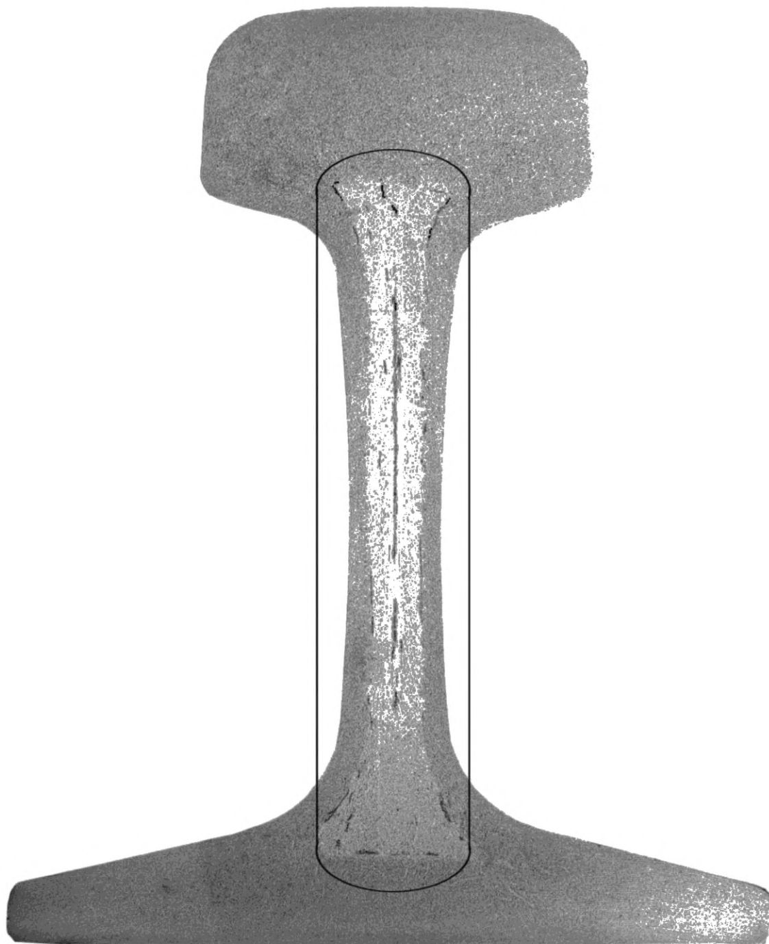
Рисунок И.9 — Несимметрично расположенные относительно вертикальной оси зоны повышенной и пониженной травимости при длине такой зоны более 15 мм (глубокое травление)
