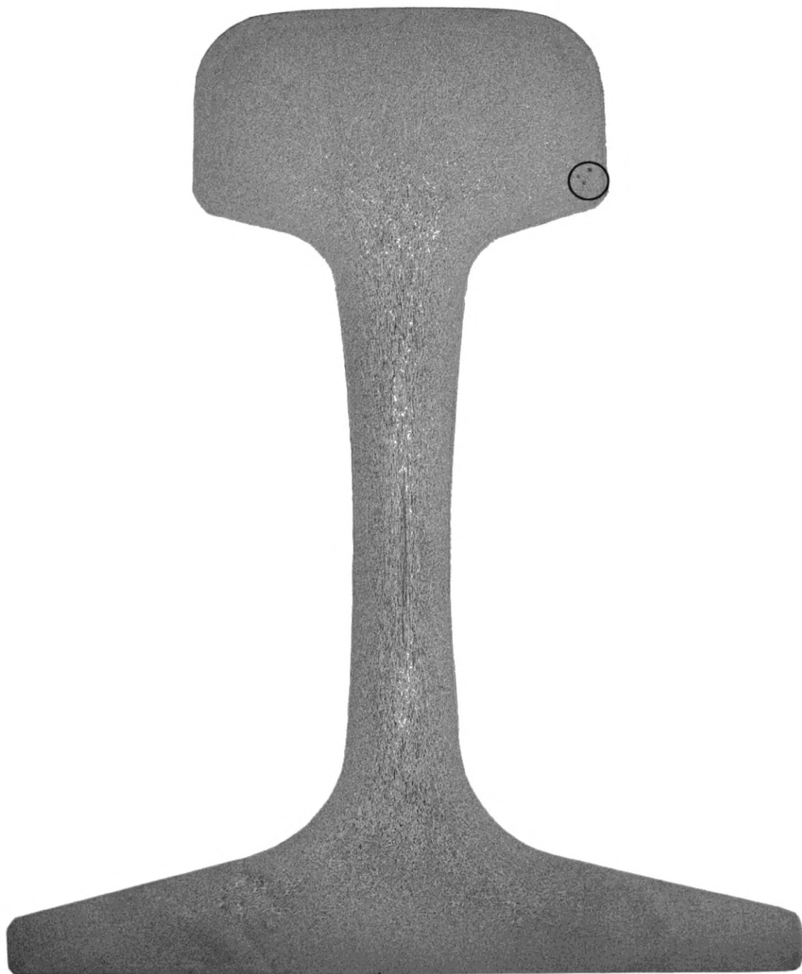
Рисунок И.13 — Скопление точек любого диаметра (глубокое травление)
