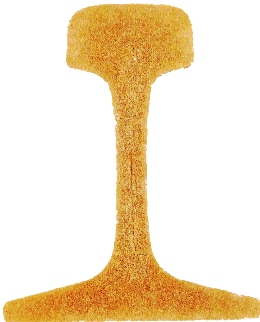
Рисунок И.5 — Незначительная прямая ликвация (серный отпечаток)
